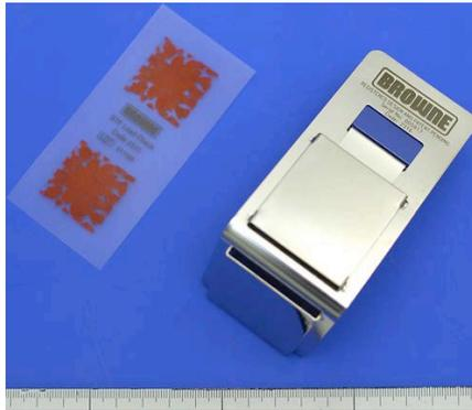
図7. WDs の洗浄効果の評価に使用する各種インジケータ
